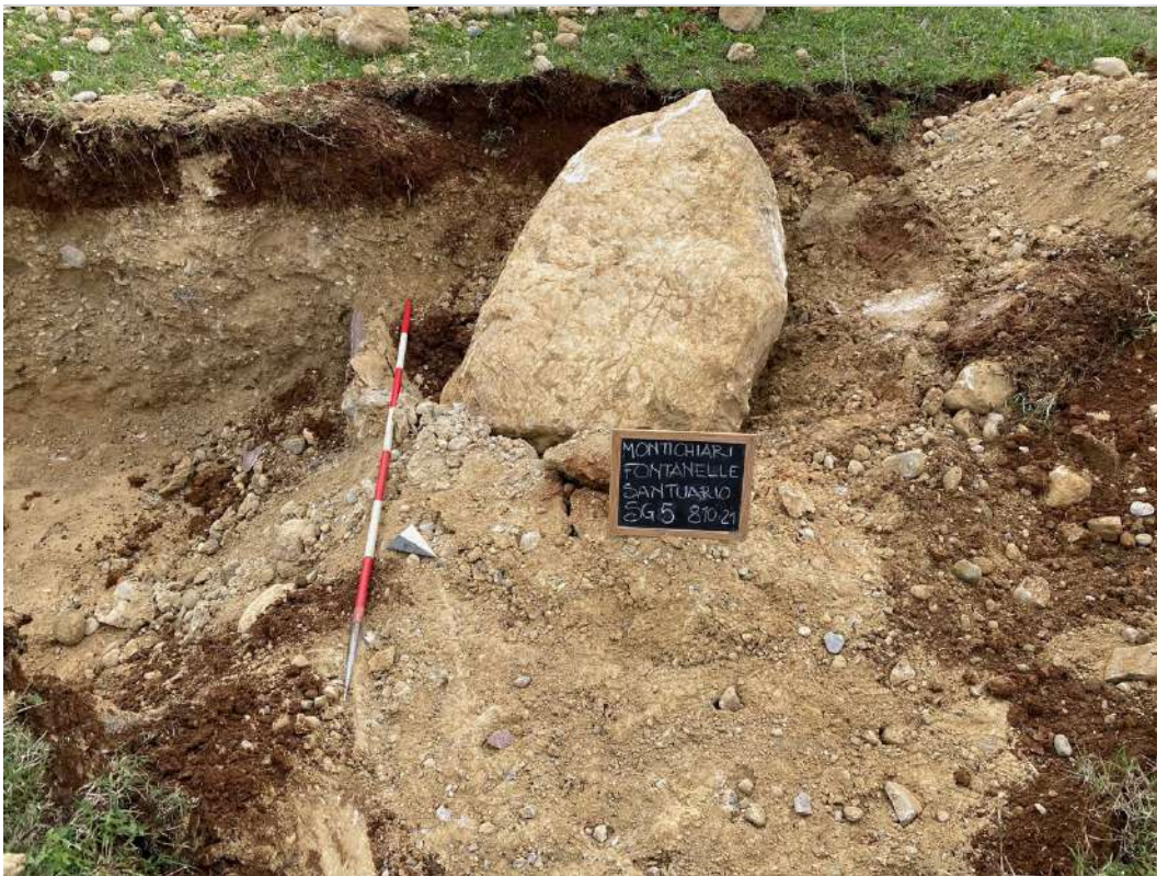
SONDAGGIO 5: GHIAIE STERILI CONTENENTI GROSSI TROVANTI
